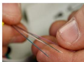
Pour être protégé, le fil de fibre optique est enrobé de résine, puis d'une gaine qui sera polissée et colorisée. Ces tubes de fibre sont ensuite disposés en rouleaux de 50 km.
