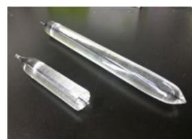
La fibre optique est créée à partir d'un tube appelé « préforme ». Ce tube est chauffé à 3 200 °C pour former une « goutte » qui est étirée sur 20 m pour devenir le fil de fibre optique !
