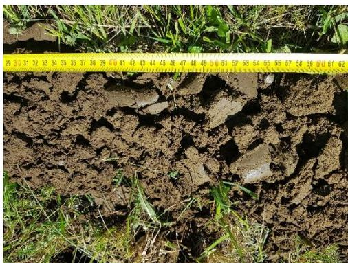
Figure 31 : Aucune trace rédoxique avant 60 cm (Sondage S1)
