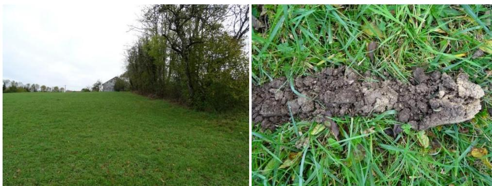
Figure 49: Traces d'hydromorphie en profondeur dans le sondage 132
