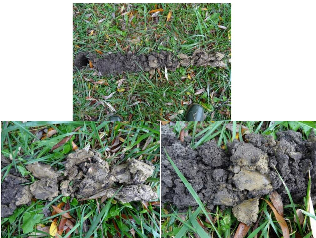
Figure 8 : En haut : Vue globale du sondage complémentaire 193 réalisé de l'autre côté de la Rue des Chevilles. En bas : deux photos zoomées des traits réductiques et rédoxiques sur le sondage 193
