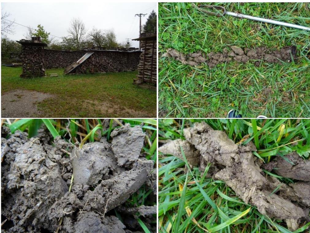
Figure 7 : En haut à droite : Vue globale du sondage 191. En bas : deux photos zoomées des marques d'oxydo-réduction sur le sondage 191.
