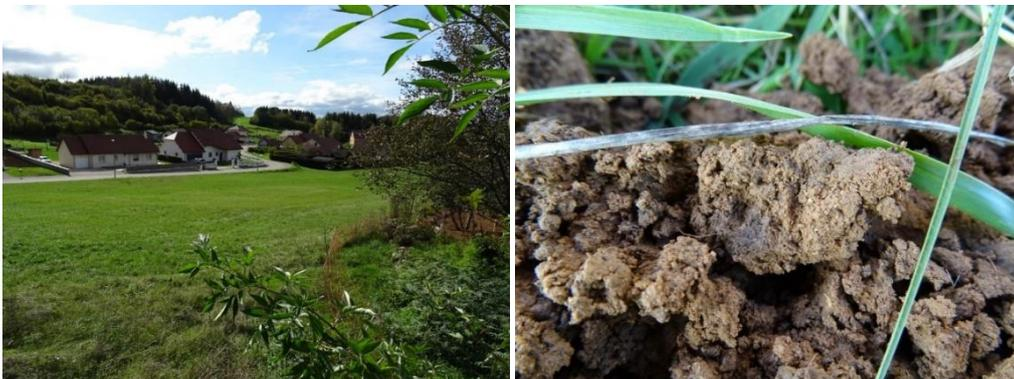
Figure 54: Traces de réduction en profondeur (après 70cm) dans le sondage 155.
