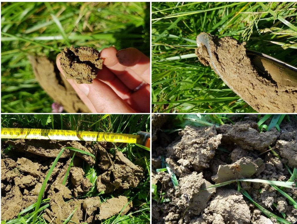
Figure 19 : Des traits rédoxiques à partir de 40 cm de profondeur puis des traces rédoxiques et de réduction à partir de 65-70 cm
