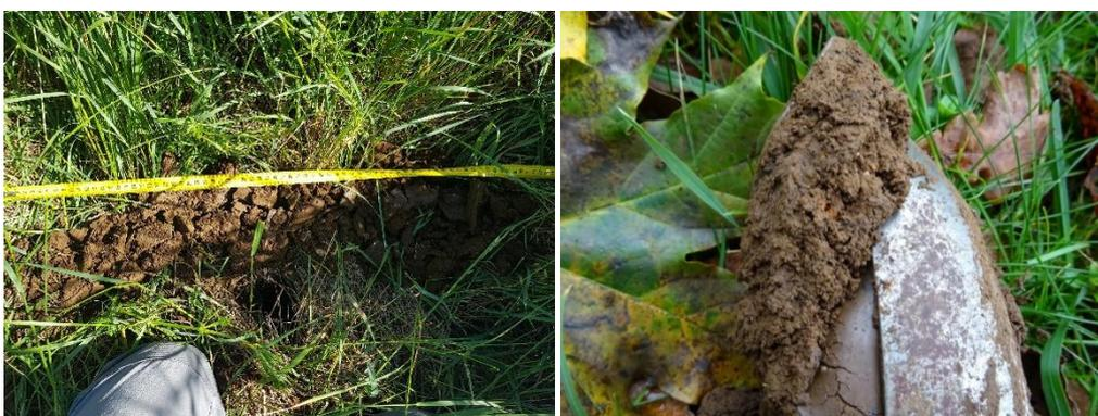
Figure 30 : Sondage 2\_27052020 (à gauche); Traits rédoxiques à environ 20 cm dans le sondage 38 (à droite)
