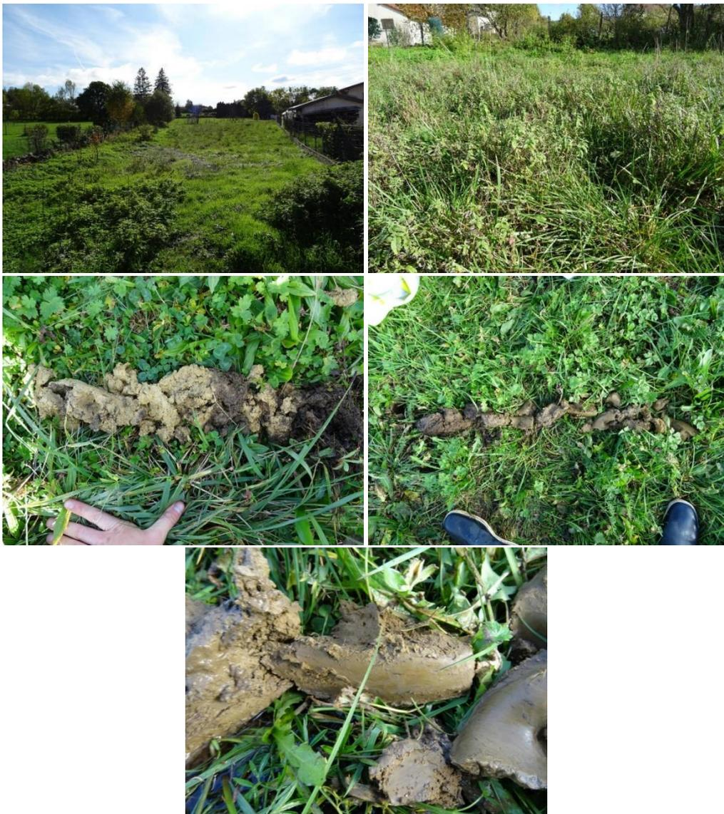
Figure 10: Traces d'hydromorphie très marquées sur le sondage 165 (centre gauche), vue globale du sondage 166 (centre droite), zoom sur les traces de réduction et d'oxydation du sondage 166 (en bas)
