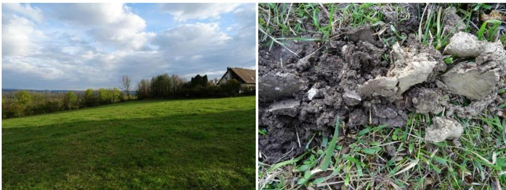
Figure 45: L'apparition d'une glaise marquée par des traces de réduction a été observée à partir de 80cm pour le sondage complémentaire 116.
